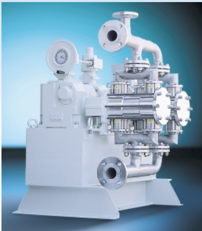
Pompa a due testate (entrambe a doppio effetto) con collettori flangiati in aspirazione e mandata. Regolazione comune tramite orologio gravitazionale. Duplex metering pump with double acting pumpheads, flanged suction and discharge manifolds, and common stroke adjustment by gravitational dial handwheel.
